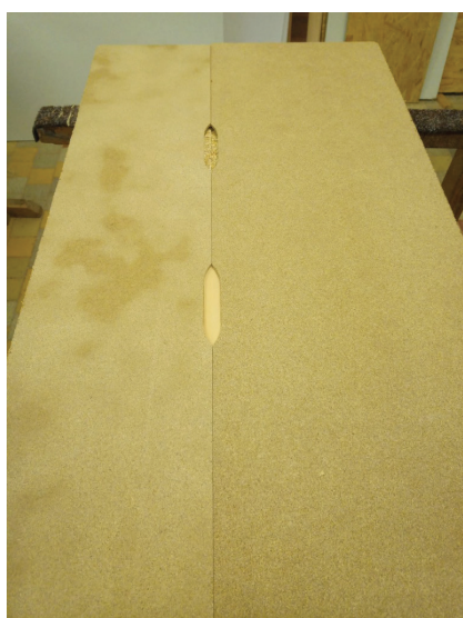
Zafrézovaná kapsa pro připevnění
