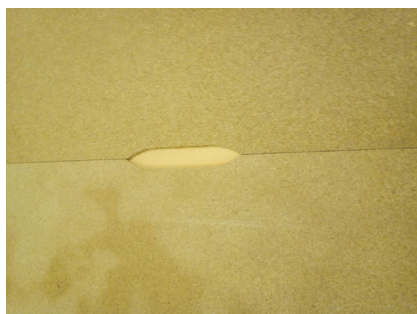
Zafrézovaná kapsa pro připevnění
