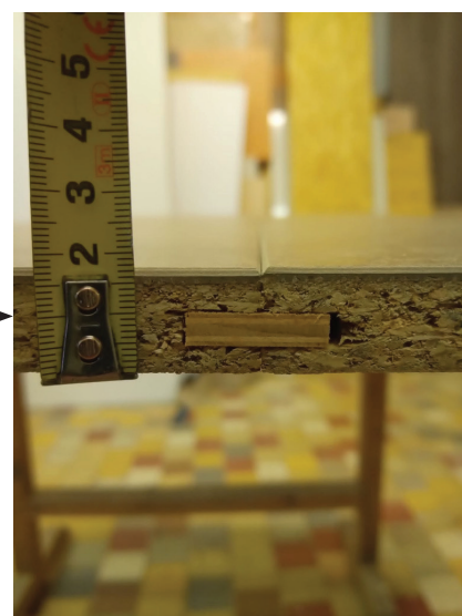
Vložené pero do drážky obkladové desky s nalepeným marmoleem
